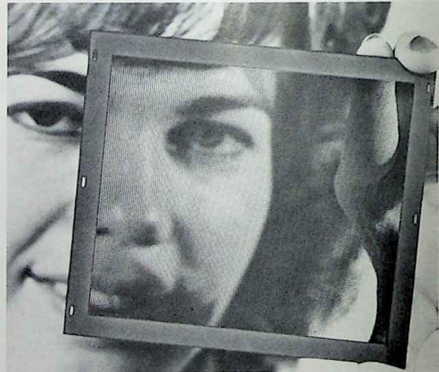
De grote gaatjesdichtheid maakt dit cellenplaatje vrijwel doorzichtig. Het is vervaardigd van een UV-gevoelige glassoort, „Fotoform B” genaamd. Dergelijke plaatjes worden toegepast in visualiseringsorganen voor cijfers en/of letters die werken volgens het gasontladingsprincipe.
